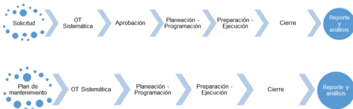
Figura 3. Flujograma de proceso de OT por solicitud y por plan de mantenimiento. (Elaboración propia).
